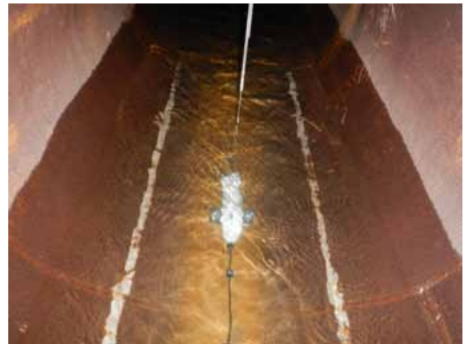
SonTek-IQ Pipeが他の流量・流速計と異なる最大の特徴は、SonTek-IQ Pipeでは、管路が満水、自由水面のどちらの状態であるかを自動的に判定して、流速を測定するための最適な方法を決定できる点です。フロー状態の情報と垂直ビーム・圧力センサーから得られる正確な水位データを使用して、流量・流速が計算されます。こうした測定を行うための追加の設定は必要ありません。
