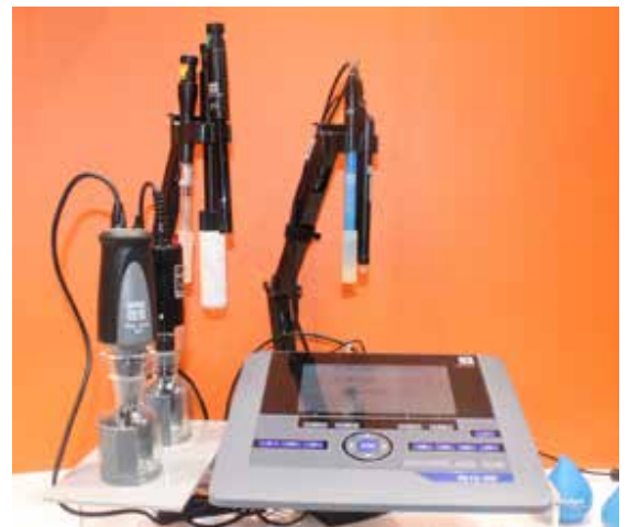
YSI マルチラボ 4010-3W (3チャンネル卓上型多項目水質計) 電導度、pH、ORP、BOD、イオン測定のためのラボ用機器。 組み合わせに関わらず、電導度、pH、ORP、DO/BOD測定用に、 マルチラボ4010-3水質計をデジタルIDSセンサーに接続、イオン 選択型電極(ISE)も接続可能です。
